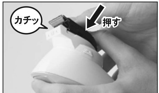
②上から押して、はめ込みます。スイッチを押して刃が左右に動くことを確認します。
